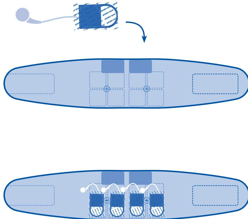
**2 pase los cables de los electrodos hacia el exterior del accesorio**
