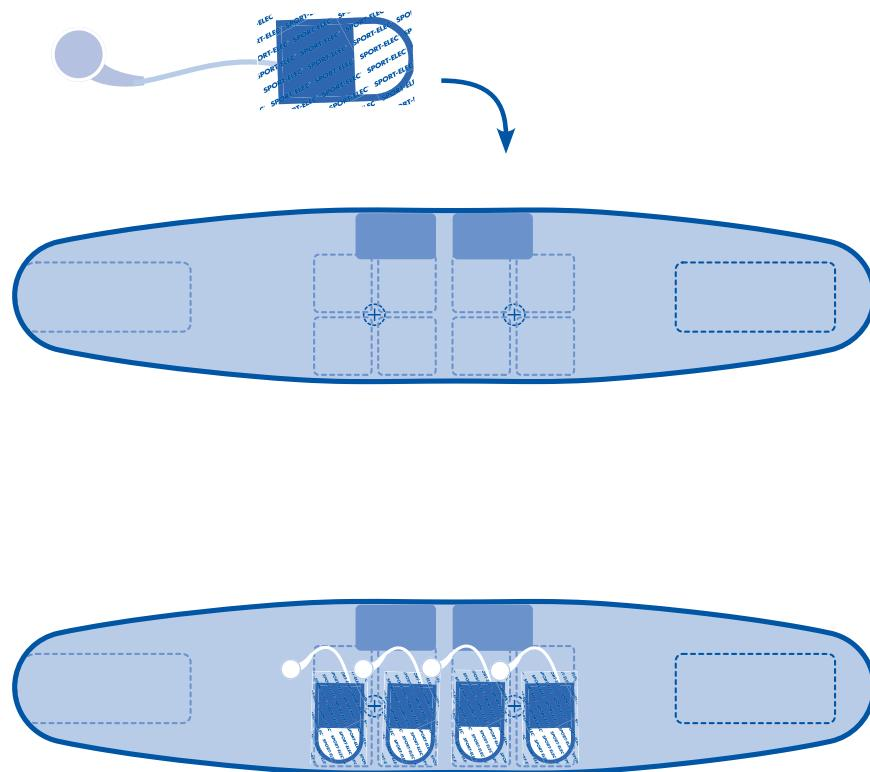
**2 Passez les fils des électrodes vers l'extérieur de l'accessoire**
